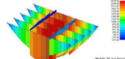
Diagramma del momento flettente nella configurazione di carico che ne massimizza il valore
